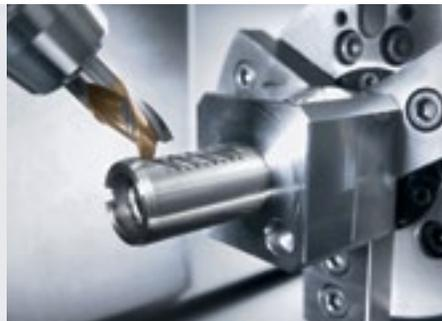
**可自动移位的中心架\*用于无振动地加工长部件, 例如轴**
