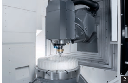
1: 在一台 ULTRASONIC 125 FD duoBLOCK® 上精磨加工耐化学腐蚀的硅石英泵壳体 2: ULTRASONIC 60 FD duoBLOCK®: 微晶玻璃制镜架的薄壁轻量结构 3: 氮化硅制的摄像机外壳
