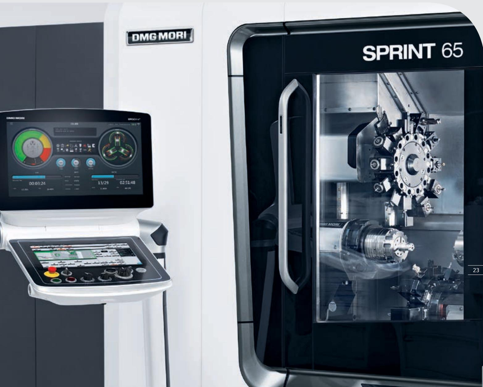
1: 先进的软件算法, 高质量、高速度地加工并缩短周期时间。超高速处理器, 插补速度快, 预读多达 1,000 个程序段, 多达 10 条路径及 40 根轴并能同时插补多达 24 根轴。
