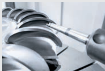
整体精加工佩尔顿轮 – \varnothing 1,600 mm 用 DMU 210 FD 完整加工
