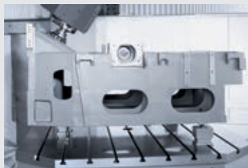
粗加工机床立柱 用 DMU 340 U 完整精加工
