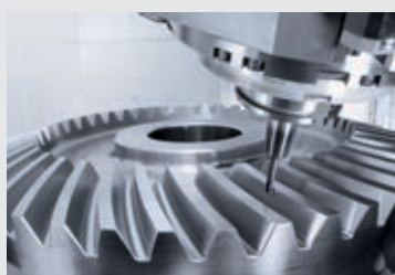
硬面加工圆锥直齿齿轮 (60 HRC) – \varnothing 1,320 mm 用 DMU 210 FD 完整加工
