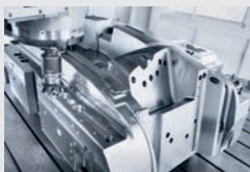
半精加工保险杠模具 用 DMU 340 P 完整加工
