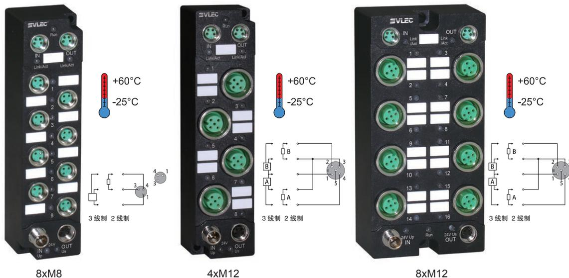
紧凑型输出 I/O 模块将来自控制器的二进制控制信号传输到处理层的执行器上。16 个输出每个都能处理最大为 0.5 A 的负载电流，但总电流不能超过 4 A。信号通过 M8 螺旋式连接器连接。输出具有短路和反接保护功能。EtherCAT 数字量输出端子盒 EP2809 将来自控制器的二进制控制信号传输到处理层的执行器上。16 个输出每个都能处理最大为 0.5 A 的负载电流，但总电流不能超过 4 A。信号通过 M12 螺旋式连接器连接。输出具有短路和反接保护功能。
