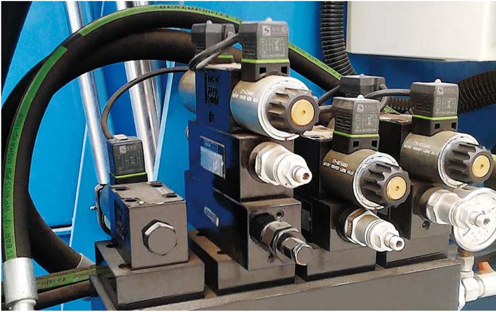
阀插头增加抑制电路后，当电路中有瞬时高电压或浪涌电流时，可以有效保护电磁阀，保证电磁阀正常工作，提高电磁阀使用寿命，有效降低了使用成本。
