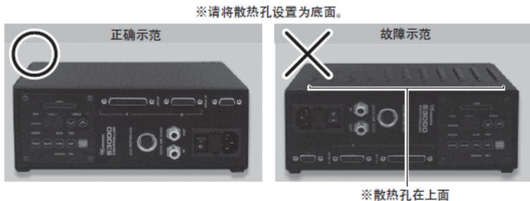
图十四：散热孔面
