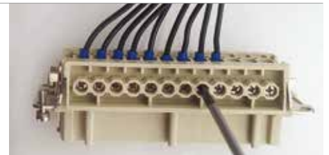
Step 3: 取出螺丝起子，弹片收回原位，从而夹紧插入的线缆。
